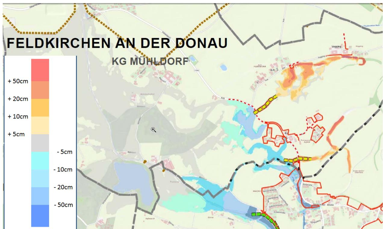
Abbildung 50: Pesenbach – HQ100 Wassertiefen Differenzplan mit und ohne Hochwasserschutzmaßnahmen
