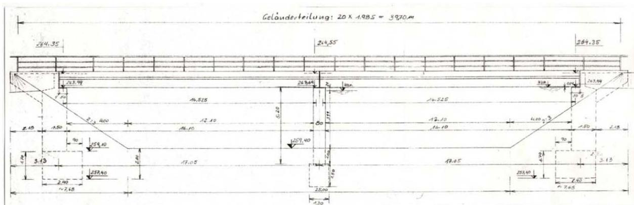
Abbildung 18: Bestandsplan der Hofhambrücke in Weidet (Quelle: AHP Hofhambrücke, Überprüfung am 5.10.2000, EBT/Salamon, Szupper, e-mail Eingang vom 23.2.2017
