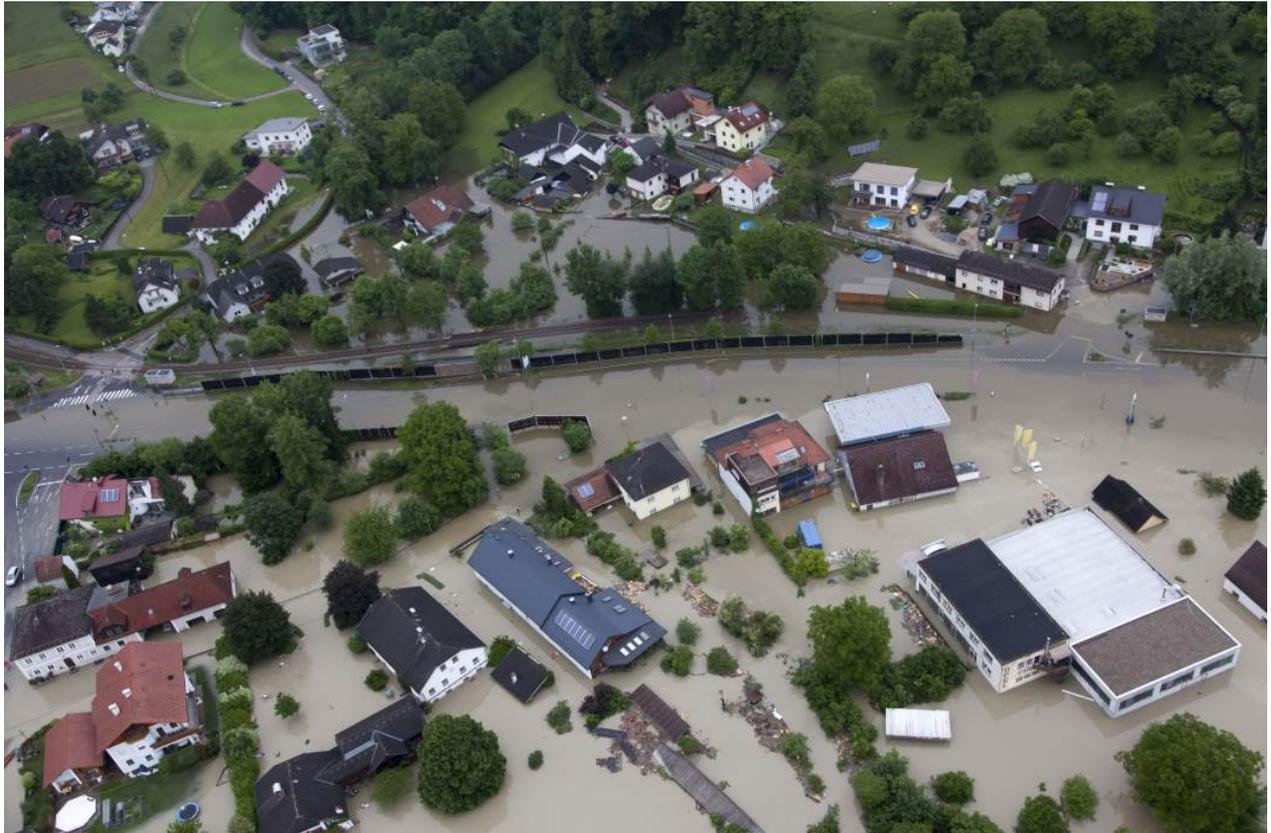
Abbildung 14: HW 2013, Ottensheim – Rückstauüberflutung durch das Donauhochwasser über den Zubringer Bleicherbach. (Quelle: Landespolizeidirektion Oberösterreich)
