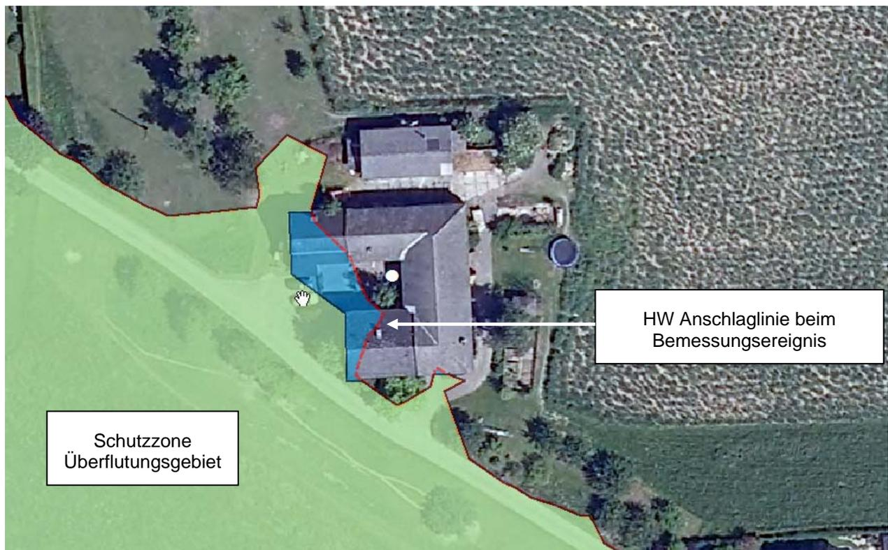
Abbildung 10: Objekte am Überflutungsrand – Ausweisung der Schutzzone Überflutungsgebiet
